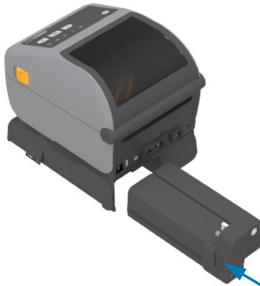
Bateria pronta para instalação
